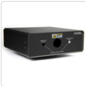
付属校正光源DT300 UV-VISで ユーザーにて校正可能
